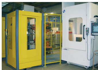
Cellule d'électro-érosion par enfonçage comprenant deux machines Makino haute vitesse
